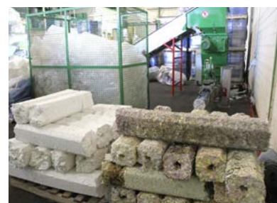
Compression du Styropor® et des mousses
